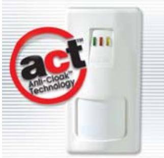
Rokonet se enorgullece de introducir la serie de detectores de intrusión **iWISE**, incorporando la innovadora tecnología **Anti-Cloak®** que actúa conmutando automáticamente del doble canal PIR/Microondas al simple canal de Microondas para dar Alarma y retorno, cubriendo de esta forma cualquier intento de robo utilizando técnicas de camuflaje para anular la radiación infrarroja.
