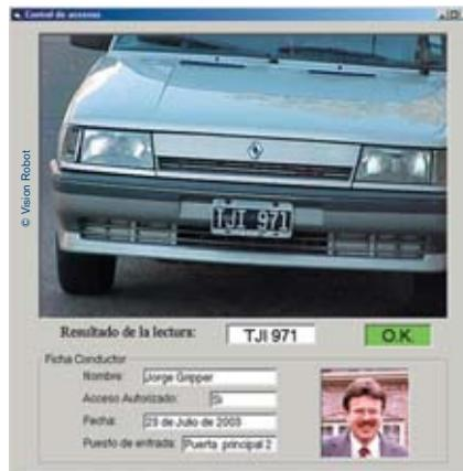
*El sistema de lectura de patentes permite controlar vehículos en plena vía pública a una velocidad de hasta 170 km./h*
