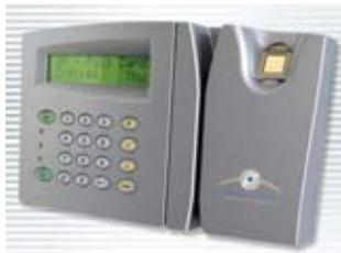
El sensor de huella digital utiliza tecnología por radio frecuencia patentada, genera una lectura protegida (*True Print*) de la imagen de la piel enterrada bajo la superficie del dedo y la compara con un perfil digital comprimido guardado y despliega los datos del usuario
