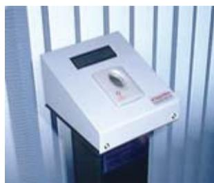
Este dispositivo ha sido diseñado para proteger archivos confidenciales y el acceso restringido a PC's. La información provista es encriptada y almacenada en archivos de disco rígido a los cuales se puede acceder solo con la autenticación de la huella digital.
