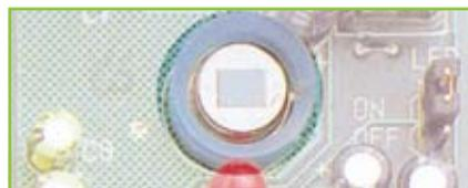
Tal como se encuentra, el detector piroeléctrico no es capaz de detectar movimiento sino variaciones de temperatura en el medio ambiente. Es necesario asociarlo a un sistema óptico que funcione como lente direccional. Se utiliza una cubierta semitransparente facetada frente al piroeléctrico denominada "lente de fresnel".
