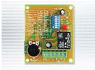
El temporizador puede programarse desde 1 segundo hasta 60 minutos. Se activa por medio de un pulso positivo o la apertura o cierre de un relay externo.
