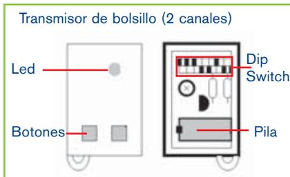
El transmisor es el elemento portátil; se alimenta de una pila de 12V, batería de 9V o pilas de reloj y tiene de uno a cuatro botones cuyas funciones dependerán del receptor o de la programación del sistema. Su alcance de acción está entre los 50 y 100m y hay modelos que con antena adicional lo amplían
