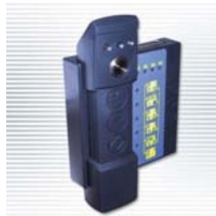
No requiere de PC para operar, permitiendo descargar la información conectando una impresora al puerto paralelo de la base. El lector mismo compone un informe que se descarga en la base, provista de un teclado multifunción que permite seleccionar qué tipo de informe quiere: detallado, de incidencias o de error.
