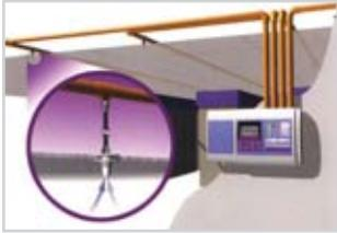
Una muestra de este aire pasa a través de un filtro de doble etapa. La primera etapa remueve polvo y suciedad antes de permitir que la muestra entre en la cámara de detección láser. La segunda etapa (ultra fina), tiene la particularidad única de proporcionar aire limpio adicional para mantener las superficies ópticas, dentro del detector, libres de contaminación, asegurando una calibración estable del mismo.
