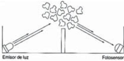
Figura 7: detector por dispersión de luz, con humo.
