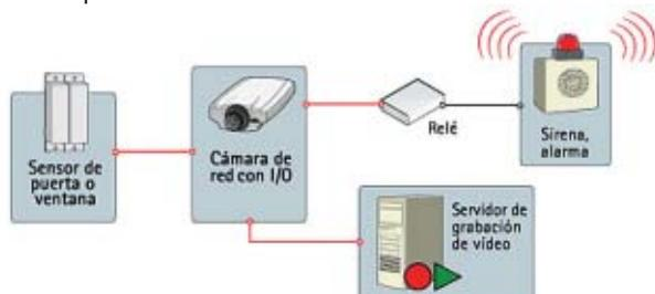
• **Entradas digitales:** La gama de los dispositivos que se pueden conectar al puerto de entrada de una cámara de red o de un servidor de video es casi infinita. La regla básica es que cualquier dispositivo pueda abrir o cerrar un circuito.
