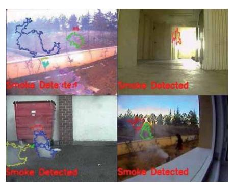
Desarrollada a fines de la década del '90, la detección de humo por video es la más novedosa tecnología en prevención de incendios. Utilizando componentes de un sistema de CCTV convencional más una central específica, el sistema puede de complementar la videovigilancia a la vez que brinda una eficaz protección contra incendios.
