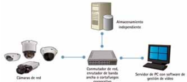
Almacenamiento conectado a red
