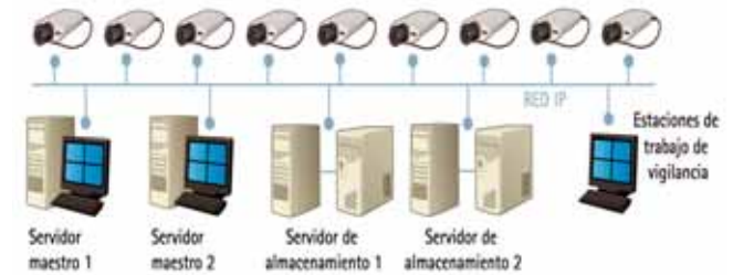
Sistema grande centralizado
