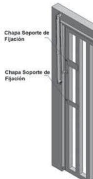
Fije el soporte de articulación de la vaina en la parte fija superior e instale la misma a través del tornillo.
