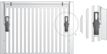
Posicione el motor sobre la hoja del portón, tomando como referencia la distancia de 100 mm entre el centro del eje principal del motor y el centro de giro del brazo de articulación del portón.
