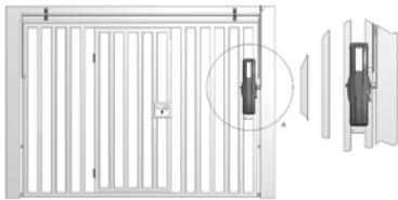
Para portones de hasta 15m<sup>2</sup> o 600 kg, se recomienda la instalación de dos motores.
