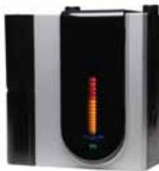
El detector de humo por aspiración de aire FAAST 8100 combina dos fuentes de detección óptica de humo (LED azul y láser infrarrojo) con algoritmos avanzados, para detectar un amplio rango de fuegos manteniendo alta inmunidad a partículas engañosas. Esto hace que el FAAST detecte con precisión condiciones de incendio incipientes, tan tempranamente como 30 / 60 minutos antes de que el fuego se desarrolle, para alerta temprana y muy temprana de incendio.
