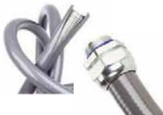
Los caños metálicos flexibles cubiertos con PVC antillama son los aliados perfectos para la conducción de cables en instalaciones a la vista, en intemperie. Su elevada resistencia al impacto y aplastamiento los tornan en un aliado perfecto para estas aplicaciones. Se proveen en 10 medidas desde 3/8" hasta 4" (diámetro interno).
