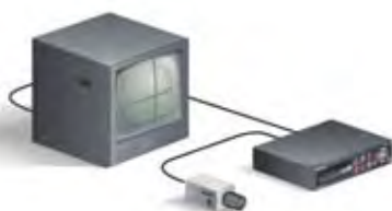
Conexión Simple a Una Cámara
