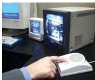
De fácil manejo: con solo apretar una tecla usted está comunicado en forma instantánea. Señalización luminosa indicando la procedencia del llamado. Capacidad: admite de 2 a 4 puestos de transmisión. Comunicación simultánea entre pares de puestos. Excelente calidad de transmisión de voz. Volumen de recepción regulable. De fácil instalación.
