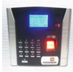
El **F4** no requiere de tarjetas de registros por parte de sus usuarios y ofrece tres modos de verificación y registro de datos: *sólo huella, pin de*
