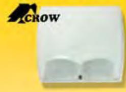
• Triple tecnología, combina piro sensores de elemento dual y tecnología de microondas • Rango de detección: 21 x 40 m con ángulo de 105° de ancho • Cubierta durable y sellada para aplicaciones residenciales y comerciales.
