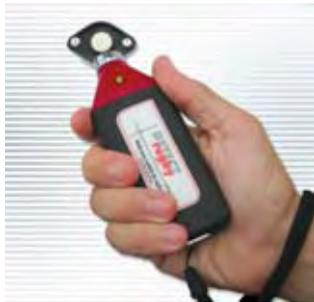
El mango cuenta en su interior con un microcontrolador de última generación alimentado con una batería de titanio de larga vida y exteriormente se recubre con un robusto gabinete de alta resistencia, construido en resina cetálica con carga de
