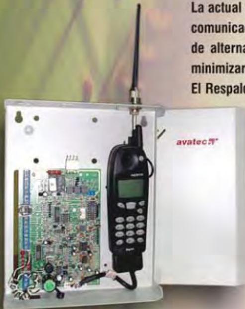
La actual vulnerabilidad de la línea telefónica fija convencional como primer vía de comunicación entre el panel de alarma y la central de monitoreo, obliga a la creación de alternativas confiables y factibles que permitan garantizar la comunicación y minimizar sus riesgos.
