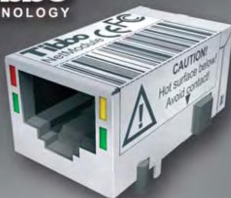
El nuevo EM202 es un convertor Ethernet 100BaseT a Serie TTL en formato de conector RJ45. El EM202 contiene la electrónica, la protección magnética, el conector RJ45 y los LEDs de estado de red en un dispositivo compacto.
