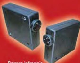
Barrera infrarroja. Haz enfocado mediante lentes y modulado en alta frecuencia para minimizar el efecto de la luz exterior. Cobertura 8 MT. Salida NA y NC - Salida 12 y 24 V.
