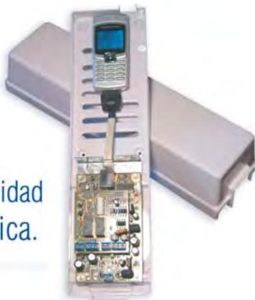
El Backup Celular RK2B de RightKey mantiene comunicados los paneles de alarma de sus clientes con su estación de monitoreo, utilizando un celular de bajo costo que se activa al detectar un corte intencional o accidental de la línea telefónica de su cliente.
