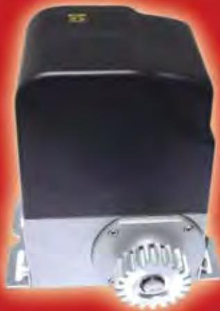
Motorreductor para portones corredizos de hasta 800 kilos. Uso semi intensivo. En baño de aceite. Con fines de carrera magnéticos y llave de desbloqueo personalizada. Apto para instalaciones al aire libre. **VERSION DE HASTA 1600 KILOS.**
