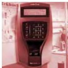
de autonomía para manejar desde 1900 hasta 4000 mil huellas y capacidad de almacenaje de hasta 8000 eventos con interfaces TCP/IP, RS232 y RS485 y Wiegand26, que podría formar parte de un sistema genérico más grande, de arquitectura abierta de control de accesos como si fuera un lector de proximidad pero sin hacer uso de tarjetas.
