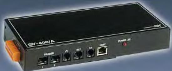
El SY-400/A forma parte de una solución completa de control de acceso. Se configura desde su PC con la ayuda del Falcon Software.
