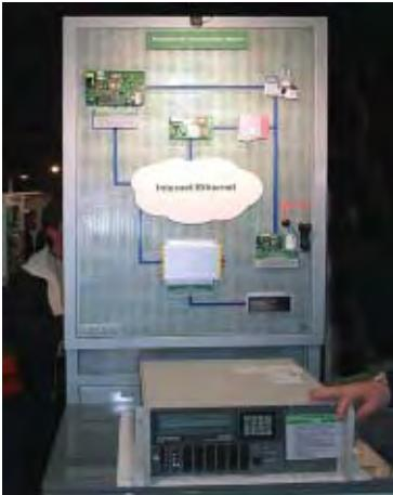
Para el monitoreo vía Internet, el nuevo módulo de captura C900V2, placa IP fija / dinámica universal Full Data con Back Up Telefónico provee en forma transparente la comunicación digital de cualquier central de alarmas con la red de datos ya existente.
