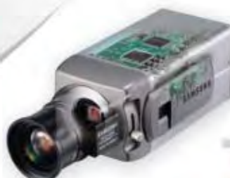
SHC-730PA Cámara color 1/3" Low Light. WDR Rango dinámico Resolución color 520tvl, b/n 570tvl Función día/noche con filtro infrarrojo
