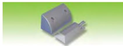
Es un magnético robusto, blindado en aluminio y preparado para colocar en una cortina metálica o portón. La ampolla viene encapsulada y con forma tal que de ser instalado en el suelo admite pesos sobre él, incluso el paso de una rueda de vehículo. La salida es precableada con un chicote metálico flexible que asegura la integridad del cable. Su alcance es de 15 a 20 mm.
