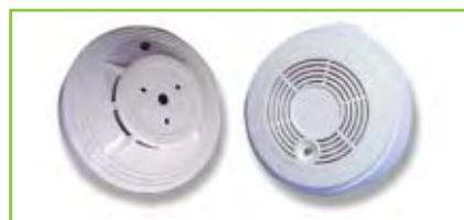
to es el de una mini barrera infrarroja en una cámara que refleja el haz. Posee unas aletas en su circunferencia que provocan el movimiento de los humos que ingresen, los que van obstruyendo la intensidad del haz infrarrojo hasta el punto límite de detección de incendio.
