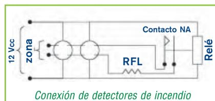
La bobina del relé está siempre energizada con los 12V de la alimentación del sensor más alejado del panel, de modo que el contacto NA de éste cierra el circuito de la RFL. Al
