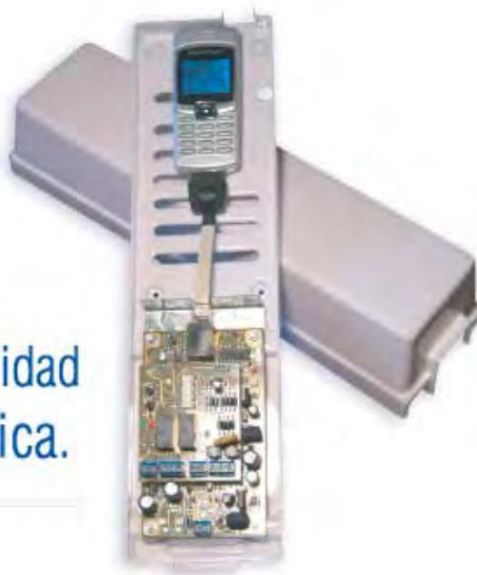
El Backup Celular RK2B Plus de RightKey mantiene comunicados los paneles de alarma de sus clientes con su estación de monitoreo, utilizando un celular de bajo costo que se activa al detectar un corte intencional o accidental de la línea telefónica de su cliente.
