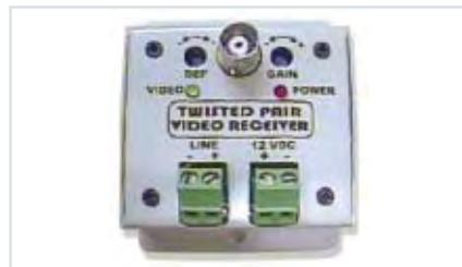
Básicamente es un amplificador diferencial de gran ancho de banda y ganancia controlable que posee una red para enfatizar las altas frecuencias. De esta forma se compensan las pérdidas de las altas frecuencias producidas en el cable.
