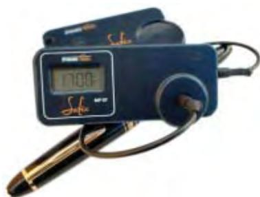
El **Safix MP-07** es un dispositivo reutilizable que cuenta con un cierre provisto por un cable de acero que se fija y remueve de un contacto trava patentado y muestra en su display de LCD la fecha y hora real del cierre, el número lógico del precinto asignado a ese cierre
