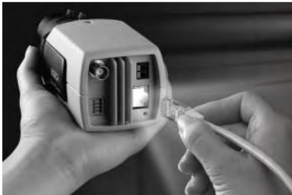
◀ Bosch ha integrado en la cámara su tecnología IP junto con funciones especiales como detección de movimiento, gestión de alarmas con salida de relé y fecha/hora, manejo de sucesos, entrada de sensor de alarma y alimentación mediante Ethernet (PoE)
