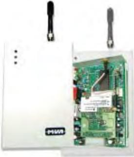
Los comunicadores GSM FDB-300 y RVA.400 utilizan los canales SMS y GPRS y operan en dos modalidades,
