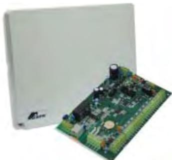
Esta generación de paneles de control les da la posibilidad de tener una central que permite domotizar, automatizar, como así también tener capacidad de control de accesos por medio de lectoras de proximidad, programables vía bus del teclado. El sistema también permite, a través de su software, crear un control de rondas. Este versátil panel se puede manejar vía radio como también comandarlo vía telefónica por medio de un módulo de voz.
