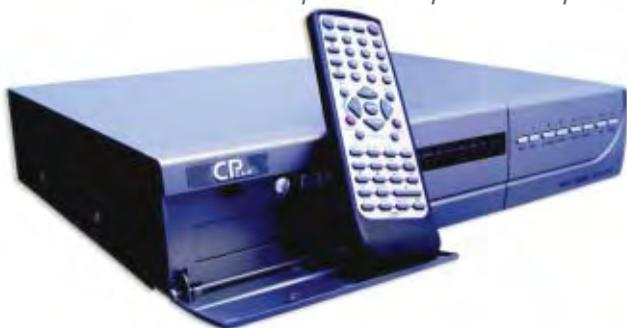
A diferencia de las que tienen base PC, las videograbadoras *Stand Alone* ofrecen mayor estabilidad sistema debido a no son afectadas por virus y permiten que el sistema no se desconecte.
