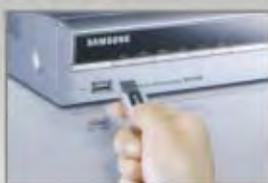
Permite la conexión de un dispositivo de almacenamiento externo, a los efectos de almacenar tanto videos como imágenes a elección.
