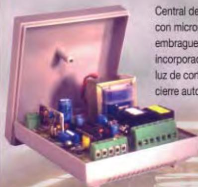
Central de mando **AVANT**, con microprocesador full: embrague electrónico, freno receptor incorporado, manejo de fotocélulas, luz de cortesía, electrocerradura y cierre automático.
