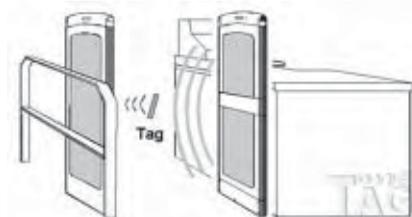
El sistema acustomagnético utiliza etiquetas generalmente escondidas debajo del código de barras del producto que resuenan a 58 KHz y tienen un concepto de utilización y funcionamiento que
