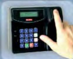
Solución innovadora que incorpora identificación de huellas dactilares 1:N y permite la apertura por ambos lados de una puerta, utilizando un solo equipo con dos lectores biométricos.
