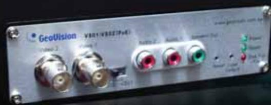
El GV-Video Server digitaliza 1 o 2 señales de video análogos, luego los comprimirá y enviará por la red IP para que sean visualizados en un dispositivo móvil, guardado en un servidor de almacenamiento o procesado por un sistema de vigilancia digital.
