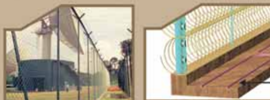
Línea Sensora En Instalación Enterrada
