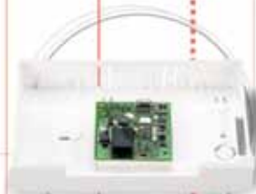
Vista ICM Módulo de conexión a Internet Permite controlar el panel via web
