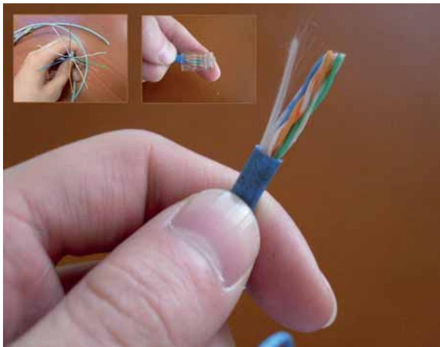
*El cable de par trenzado o UTP es uno de los más utilizados en la industria de la seguridad, principalmente el denominado de Categoría 5, para el tendido redes o circuitos de CCTV. En este informe ofrecemos las características y usos de este cable, añadiendo una comparativa con otros cables utilizados en el sector.*
