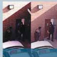
**La Compensación de Rango Dinámico** modifica los niveles de luz variables para obtener una imagen balanceada y uniforme.
