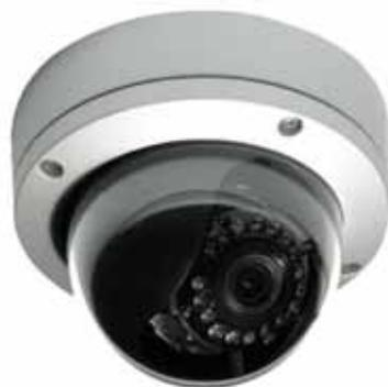
La cámara MiniDome integrada WZ45N es una sencilla cámara antivandálica de montaje en superficie diseñada para una efectiva vigilancia permanente. Equipada con un CCD de filtro mecánico de 520 líneas de TV y 18 LED de gran eficacia, la cámara WZ45N provee un color intenso durante el día y 18 metros de visión nocturna con infrarrojos activos.
