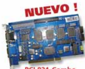
PCI 831-Combo Placa apilable, soporta 32 cámaras, 200FPS
