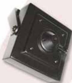
MFC 4007 Cámara miniatura Color CCD, lente 3,7mm Flat pinhole, 1/4 sharp 420 tvl c/audio. Inc. Soporte.
