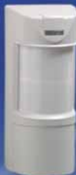
EDS 3000-TRIO Sensor para exteriores con PIR Quad y microondas Cobertura ajustable entre 90° y 180° Óptica y electrónica sellada Antiensucamiento Salida de relé de tiempo ajustable Potente filtro de luz solar y luz blanca Inmunidad a emisiones RF Antimascota hasta 40Kg. Microondas banda K
