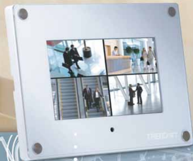
Monitor SecurView de 7" para cámara inalámbrica TV-M7
