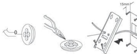
**d-** Para montaje de la unidad sobre pared resulta ideal usar una caja embutida en la pared para la acometida de los cables de ésta a la parte posterior del sensor.
