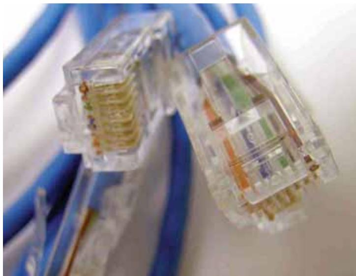
suministre energía a la cámara, video analógico y datos PTZ en el presente. Muchas compañías proporcionan transceptores que entregan estas señales sobre una estructura UTP EIA/TIA568B. Esta solución de transmisión ha probado ser confiable, fácilmente disponible y proporciona señales en tiempo real de alta calidad, que se conectan fácilmente por medio de un codificador o NVR a la red IT.
