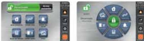
Para acceder a las teclas Fuego, Auxilio, Pánico (FAP), los usuarios sólo necesitan presionar el botón de EMERGENCIA en la barra lateral.
