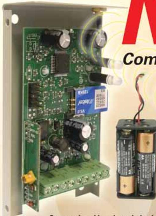
Conectados al bus de teclado sin intercalarse en la conexión a línea telefónica del panel, se obtiene una solución más confiable, con menos consumo de energía, agrega prestaciones integradas con el panel y en un diseño compacto.
