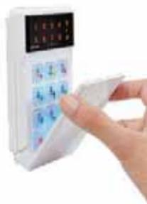
el consumo disminuyendo la intensidad del backlight. De esta manera, aumenta la durabilidad de la batería general del sistema.
