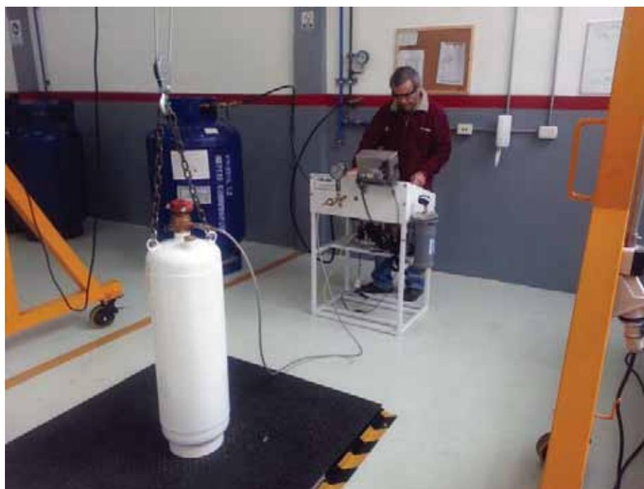
Se vuelve a verificar que no haya pérdidas y se deja estabilizar la mezcla durante 48 horas; luego de este período se controlan una vez más las presiones y que no haya fugas. El otro proceso específico es el taladrado de las toberas, que deberán contar con orificios del tamaño, forma y distribución exactos que haya determinado el Software de Cálculo en función del recorrido de toda la cañería y su correcto balance y funcionamiento.
