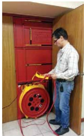
Estos sistemas tienen como mecanismo la inundación del recinto con el agente extintor; la normativa indica que el recinto debe mantener la concentración del agente aún después de extinguido el fuego para evitar que vuelva a iniciar. Es fundamental, entonces, que el recinto no tenga fugas y pueda mantener la estanqueidad durante un período de tiempo determinado.
