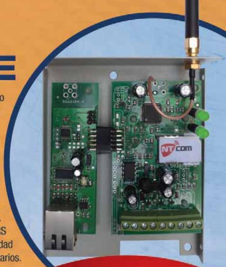
En muchas instalaciones hay líneas telefónicas digitales no aptas para la transmisión de eventos, sin embargo el mismo prestador provee servicios de internet y en este caso se puede utilizar dicha conexión como reemplazo de la línea fija.
