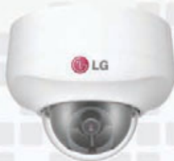
LND-3110R 1,3 Megapixel, 1280*1024, WDR Exterior IP66, Lente 4mm F2,0 Día/Noche Vía Filtro ICR, 14 Leds Infrarrojos, Distancia 20 Mts, DC 12v
