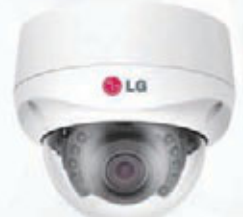
LCV-5300R Día/Noche Vía ICR Iluminadores infrarrojos Antivándalico (IK10) Intemperie Total (IP66)
