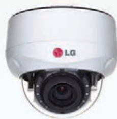
LNV-7210R Antivandalica IK10, Exterior IP66 2,1 Megapixel 60 Fps, 1920*1080 Lente 3*9mm F 1,2 (zoom X3) Memoria SD. Día/Noche Vía Filtro ICR 32 Leds Infrarrojos, Distancia 30 Mts Video Analítico. 1 Salida De Video. POE / DC 12v
