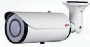
LNU-7210R Antivandalica IK10, de exterior IP66, 2,1 megapixel 60 fps, 1920*1080 Lente 3*9mm F 1,2 (zoom x3) Memoria SD. Día/Noche vía filtro ICR 32 leds infrarrojos, distancia 30 Mts. Video analítico. Audio dos vías 1 salida de video. POE / AC24v /DC12v
