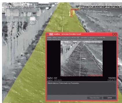
El fabricante de *software* Digifort cuenta con un potente motor de analíticas de video que se integra a su VMS. Así, Digifort VCA permite trabajar en conjunto con cámaras térmicas Dahua para seguridad. Una gran proporción de los eventos de inseguridad suceden en condiciones
