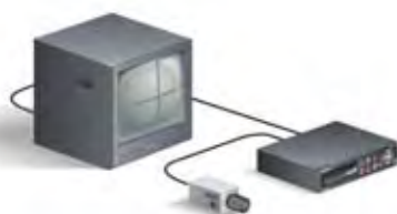
Conexión Simple a Una Cámara
