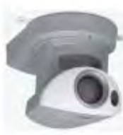
AXIS 213PTZ Compresión MPEG-4 ASP Sensor imagen 1/4" Sony ExView HAD Interfaced CCD Tipo de lente 3.5-91mm auto iris y auto foco. 26X zoom óptico 12X zoom digital. Sensibilidad a la luz 1Lux (Color) Alarma IO 1/1
