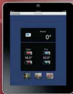
Control de climatización por zonas
