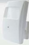
COPIR - AR Sensor video 1/3" Color CCD SONY 700 VL. 12VDC -0,1 LUX Lente 3.6 mm / 6 mm
